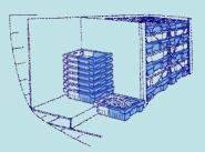
Utilisation d'une cale réfrigérée à la température de 5 - 8°C Conditions Optimales:
