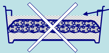
Lit de glace du dessus incomplet
